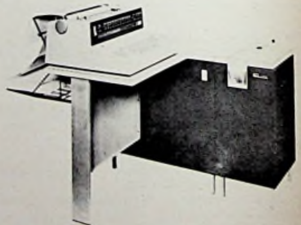
Het IBM 1050 informatie communicatiesysteem zendt en ontvangt met een snelheid van 14,8 tekens per seconde (135 bits/sec.) en is te gebruiken voor transmissie van gegevens en het vastleggen van informatie in voor de machine leesbare vorm. De 1050, die werkt met de BCD-code, kan naar wens worden uitgerust met een kaartlezer of een papierbandlezer, eventueel met papierbandpompmachine.
